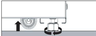
3 - Con un nivel de burbuja, colóquelo sobre el vidrio de la parte superior y gire manualmente un pie a la vez, ajustando la altura según sea necesario.
