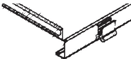
Fije el perfil del portaetiquetas al soporte colocando la parte superior en el canal y, a continuación, presionando el perfil contra el soporte.
