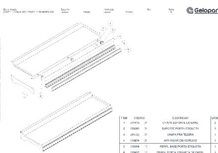
Coloque el soporte del soporte de etiquetas en la parte delantera de la placa del estante.
